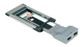
. 2 قم بتثبيت بطاقة ExpressCard مع المحول بنفس الطريقة التي يتم بها تثبيت بطاقة PC Card. انظر تثبيت بطاقة PC Card.
