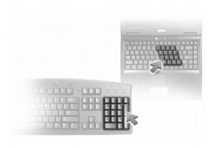
تعمل لوحة المفاتيح الرقمية مثل لوحة المفاتيح الرقمية الموجودة على أي لوحة مفاتيح خارجية. يقرم مفتاح على لوحة المفاتيح بوظائف متعددة. يتم تعليم أرقام ورموز لوحة المفاتيح باللون الأزرق إلى يمين مفاتيح لوحة المفاتيح. كتابة رقم أو رمز، استمر في الضغط لأمظ على المتقاح المطلوب.
