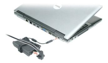
يحول محول النيار المنزدد النيار المنزدد الين تيار ثابت وهو ما يلزم لتشغيل الكمبيونز يمكنك توصيل محول النيار المنزدد بالكمبيونز سواء كان قيد التشغيل أو ايقاف التشغيل.
